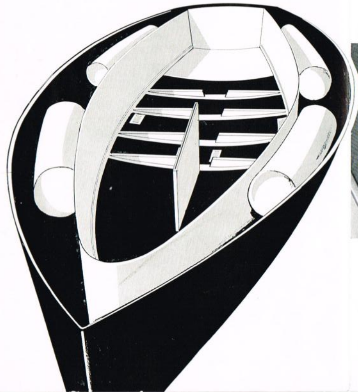
Die Bodenbretter sind mit Glasfaser überzogen, so dass Sie nicht ausrutschen können. Vier Elvstrøm Lenzer sind eingebaut, und sie sind alle auch am Wind wirkungsvoll.
