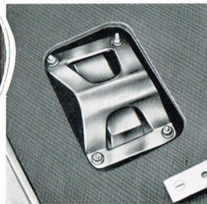
Die Bodenbretter sind mit Glasfaser überzogen, so dass Sie nicht ausrutschen können. Vier Elvstrøm Lenzer sind eingebaut, und sie sind alle auch am Wind wirkungsvoll.
