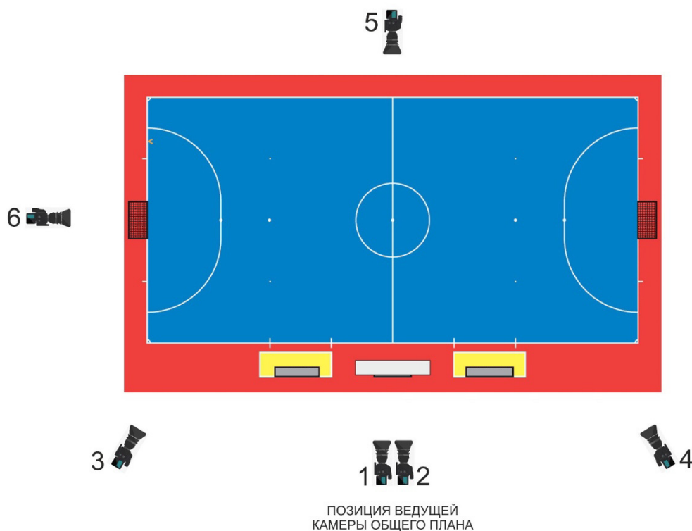
Рисунок 2. Рекомендуемая схема расстановки камер при организации телевизионных трансляций.
