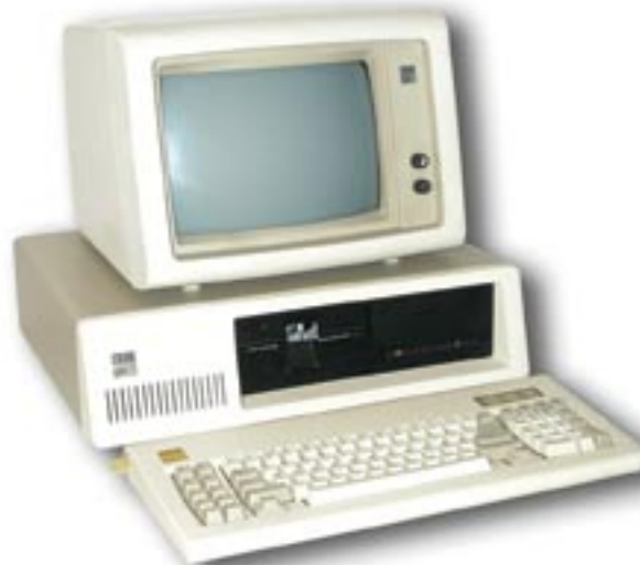
IBM PC XT (1985): 256k RAM, drive: 3.5" FDD, Intel iC8088, hastighed: 4.77 MHz, skærm med 16 farver, harddisk: 10 Mb, MS DOS medfølger.
