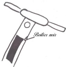
Le plus simple est de taper sur le boîtier noir avec une masse. Un tournevis peut aussi aider.
