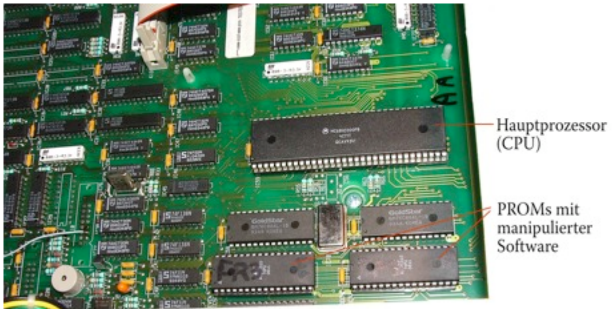
Hauptprozessor und PROMs auf Chipsockeln
