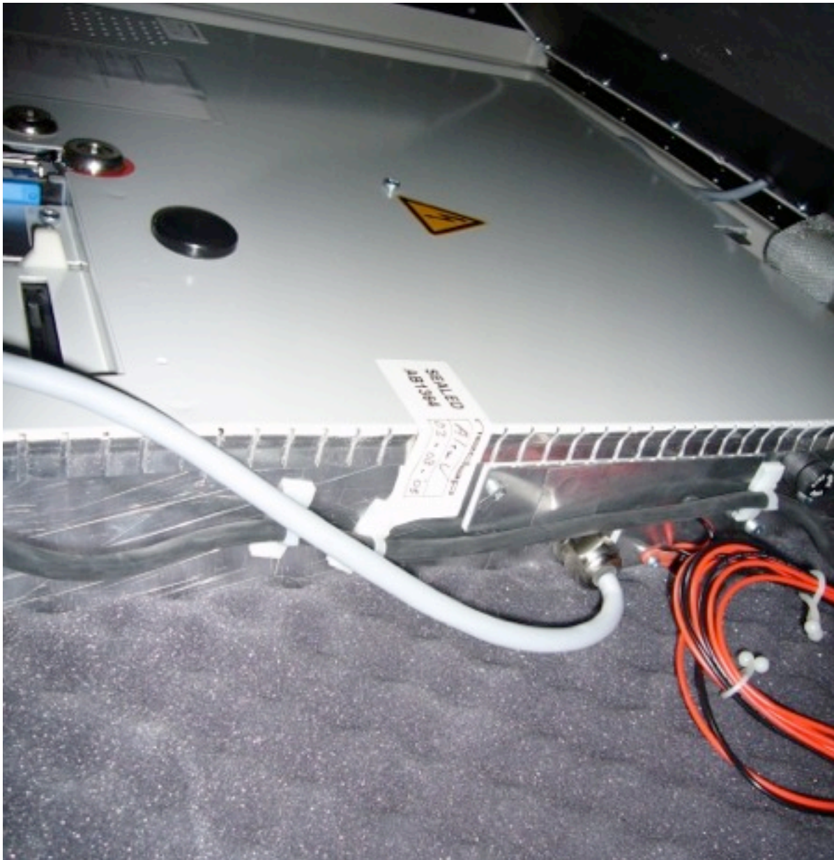
„Siegel“ am Computermodul eines deutschen NEDAP-Wahlcomputers
