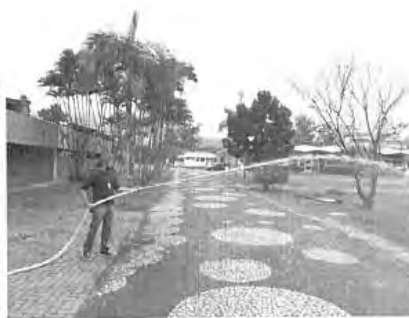
Foto 04 - Hidrante fundos - alcance do jato
