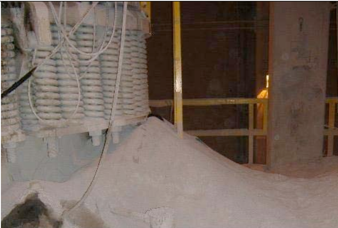
Foto No. 4: Alto contenido de polvo sílice en el área de trabajo de Concentrado
