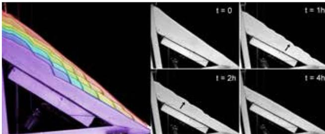
Évolution de la morphologie du tas humide de billes sous l'effet de l'érosion de l'écoulement des grains secs. Superposition d'images acquises régulièrement et colorées en post-traitement. © G. Lefebvre et P. Jop, SVI, CNRS/Saint-Gobain
