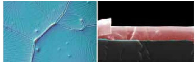
(gauche) Visualisation de joints de grains au sein d'une pérovskite hybride par microscopie optique polarisée. (droite) Vue en coupe par microscopie électronique à balayage d'un empilement multicouches au sein d'une cellule pérovskite. © Los Alamos National Laboratory
