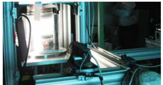
Dispositif expérimental : 2 caméras placées orthogonalement permettent de suivre les mouvements des particules dispersées dans le fluide placé dans le récipient éclairé. 2 turbines contrarotatives (haut et bas) mettent le fluide en mouvement. L'ensemble est convenablement thermostaté. © Luc Barbier - CEA
