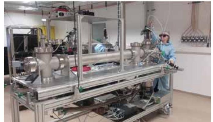
Dispositif expérimental : on distingue, devant l'expérimentatrice, l'enceinte où les atomes d'hélium sont photoionisés. Les électrons éjectés sont guidés par un champ magnétique vers un détecteur situé dans la cellule de gauche. Entre les deux, le long temps de vol de 2 mètres de long permet d'analyser en énergie les électrons émis avec une résolution de ~ 0.2 électron-volt. © M. Turconi – CEA.
