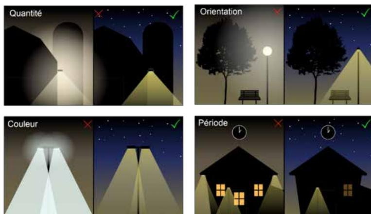
Figure no 15. Les 5 principes d'éclairage de base pour diminuer la pollution lumineuse (X= mauvaise pratique, ✓= bonne pratique).
