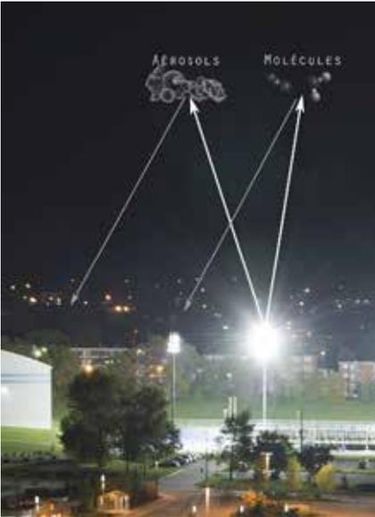
Figure 3. La lumière émise par les sources artificielles est réfléchiée sur différentes surfaces et est diffusée dans l'atmosphère en interagissant avec les particules en suspension dans l'air (molécules et aérosols). Cette diffusion génère des halos lumineux qui masquent le ciel nocturne et perturbent l'intégrité nocturne. Plus il y a de pollution atmosphérique, plus il y a de particules en suspension et plus il y a de pollution lumineuse.
