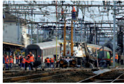
Le 12 juillet 2013, l'accident de Brétigny-sur-Orge survint à la suite de la défaillance d'une éclisse venue se loger dans un aiguillage ; il causa la mort de sept personnes.
