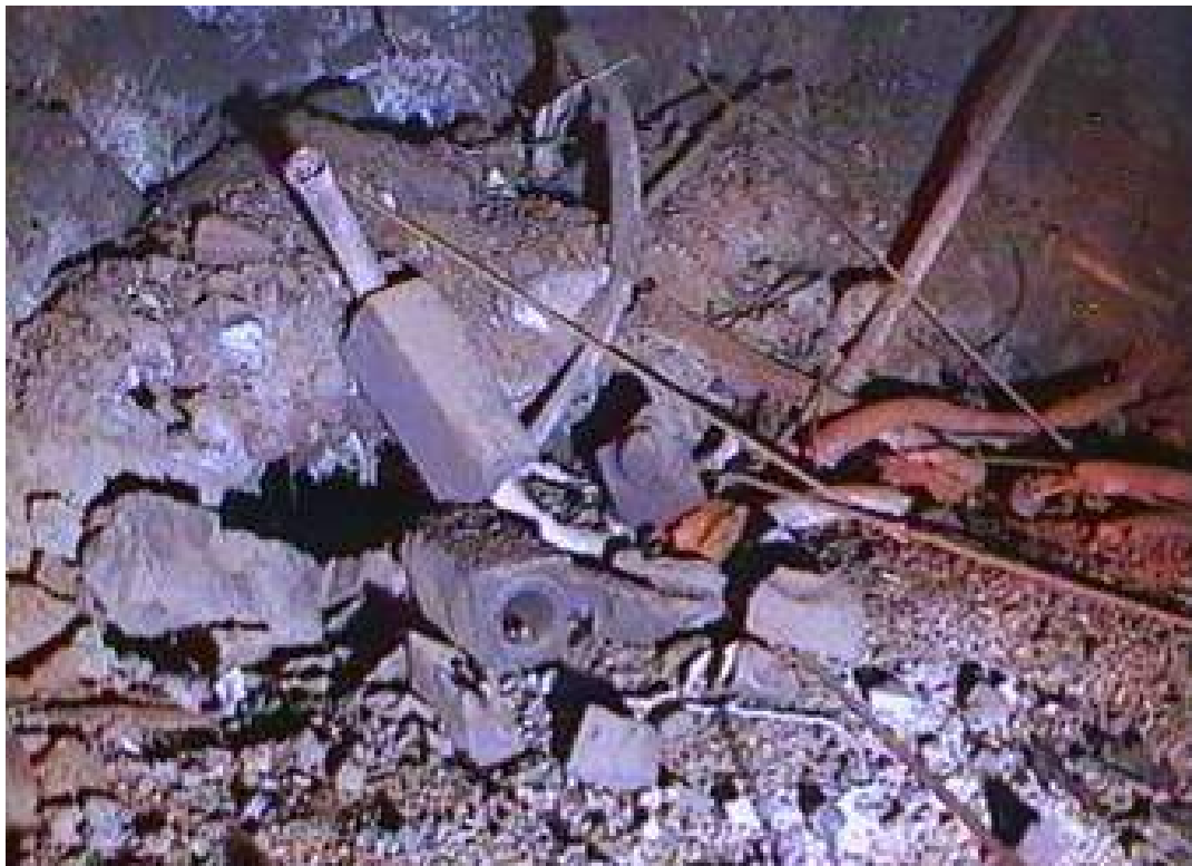
Рис. 5.1. Фрагменты активной зоны разрушенного реактора в помещении 305/2.
