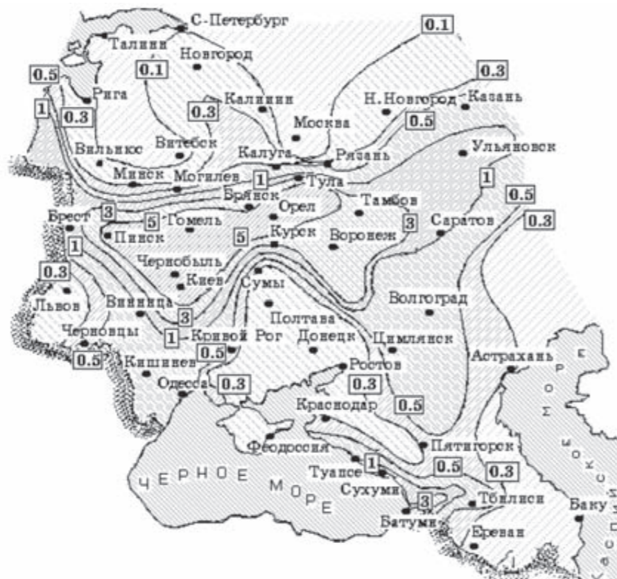
Рис. 2.1 Карта-схема загрязнения территории ЕТС ^{131}\text{I} , построенная по данным измерений его выпадений на планшеты и результатам реконструкции по выпадениям ^{137}\text{Cs} – изолинии восточнее направления «Сумы – Брянск»
