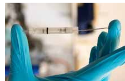
Cellule électrochimique pour étude de matériaux de batterie en RPE, 7 × 55 mm.
