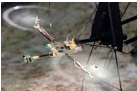
Le robot BeeRotor, équipé d'un œil inspiré des insectes.
