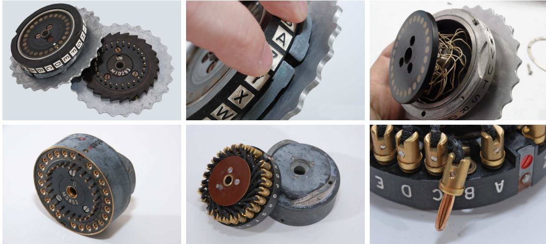
Figura 13. De izq. a drcha. y de arriba a abajo: 1. Rotores de la Enigma. La parte posterior del rotor izqdo. muestra una muesca en la letra H (cada rotor tenía la suya) causante del giro de una posición del siguiente rotor situado inmediatamente a la izquierda. Por ejemplo los rotors I, II y III, tenían estas muescas en las letras Y, M y D, que provocaban el giro del rotor situado inmediatamente a su izquierda en las letras Q, E y V respectivamente. Inclusive la Kriegsmarine introduciría dos nuevos rotors (el IV y el V) que tenían doble muesca (los rotors de la 1ª imagen son de este tipo), y causaban un aumento del número de giros de los mismos. 2. Disposición del anillo que se podía modificar para cambiar la configuración del cableado interno y la muesca del rotor. 3. Cableado interno de un rotor (diferente en cada rotor). 4. Reflector. 5. Interior del reflector. 6. Clavija interna del reflector modificable. 14
