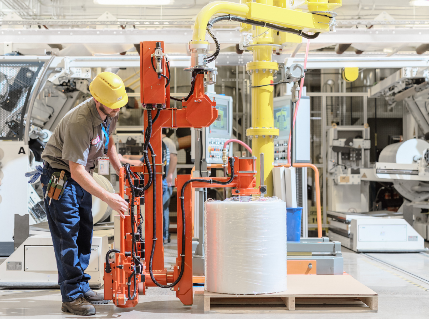
一位作業員使用操作機安全地將一捲塑膠放置在貨板上。
