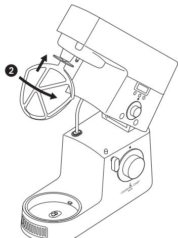
**Vigtigt** – Hvis mikserhovedet er løftet på noget tidspunkt mens den er i gang, vil mikseren automatisk stoppe og bippe, og den vil ikke starte igen indtil mikserhovedet er sænket. For at starte mikseren igen, drejes hastighedskontrolle til off 'O'-positionen, og der vælges igen en hastighed.
