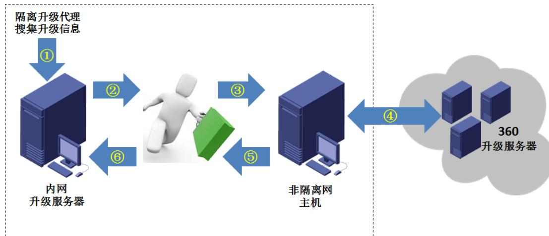
图 5-2 物理隔离网升级流程
