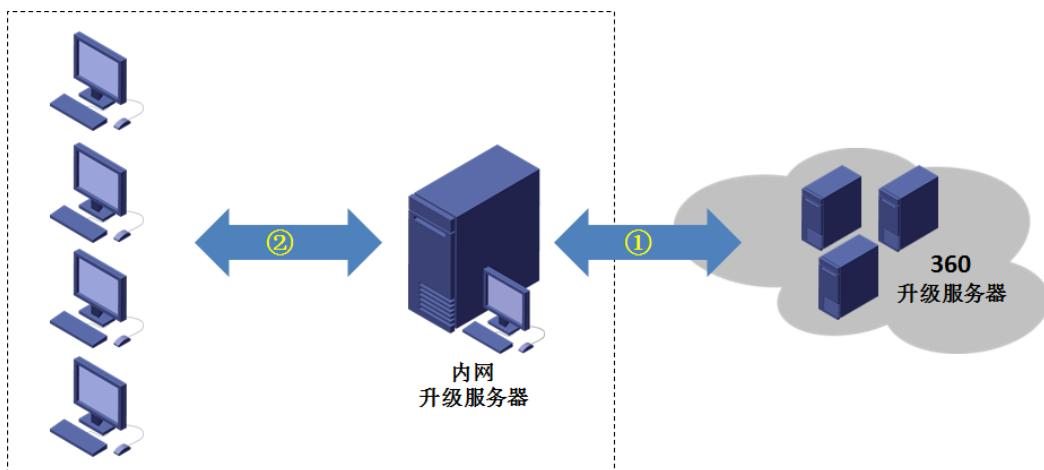
图 5-1 内网推送方式升级流程
