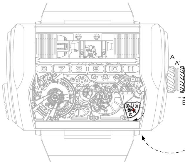
L'indicatore della riserva di carica è visibile sul fondello dell'H3
