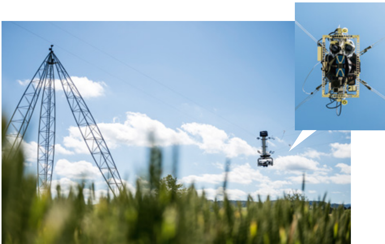
Inspiration Fussball: Die Phänotypisierungsanlage der ETH-Forscher lehnt sich an das Spider-Cam-Prinzip an.
