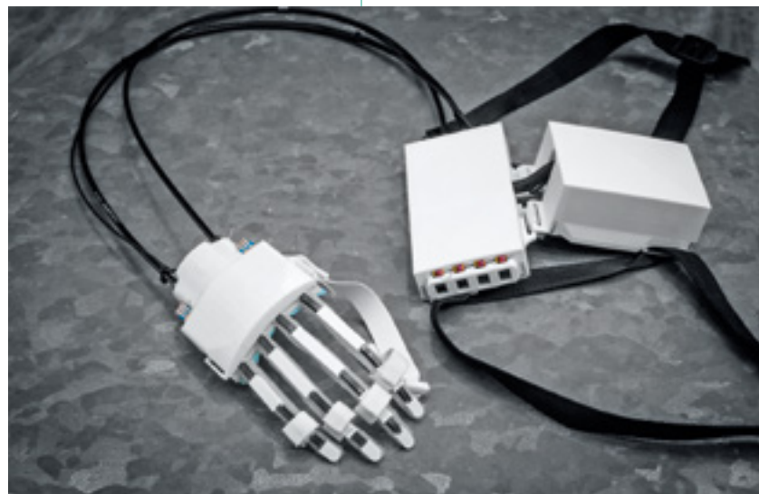
Das Hand-Exoskelett mit den Motoren, die am Rücken getragen werden: Ein Velobremskabel überträgt die Kraft, die ausreicht, um eine Literflasche Wasser zu heben.
