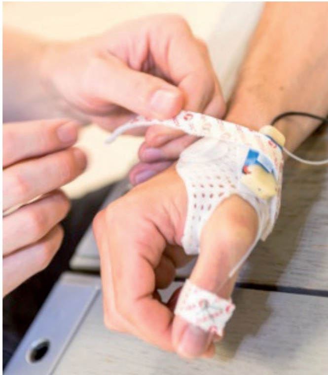
Illustration 20 – Exemple de projet réalisé au sein d'Ideas Laboratory® : capteurs pour un gant connecté
