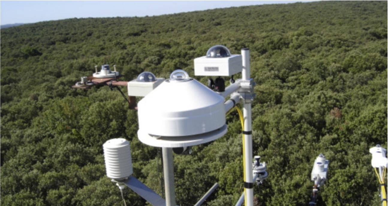
Station de mesure du réseau Ecosystèmes ICOS, forêt de chêne vert, Montpellier (© CNRS)
