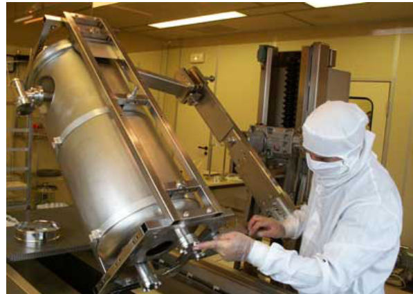
© IPN - Conditionnement d'une cavité accélératrice en salle blanche
