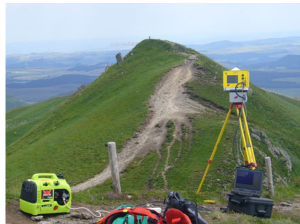
Numérisation par laser-scanner 3D du Puy de la Perdrix dans le cadre d'un programme de suivi de sentier en partenariat avec le Parc Naturel des Volcans d'Auvergne ©Véodis-3D
