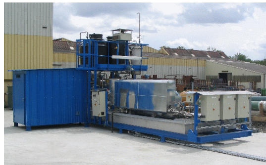
Pilote d'oxydation supercritique OSTAU - Source : INNOVEOX
