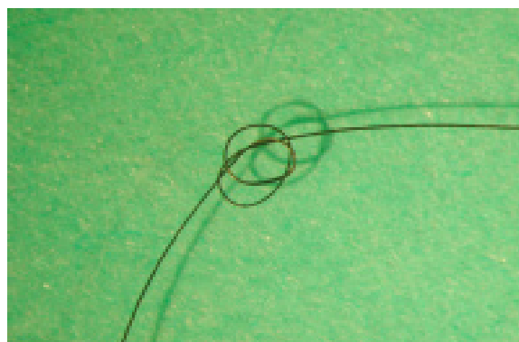
Fibre obtenue a partir du filage de nanotubes de carbone
