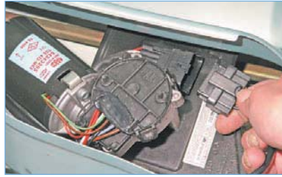
...отсоединяем колодку жгута проводов от колодки проводов мотор-редуктора.
