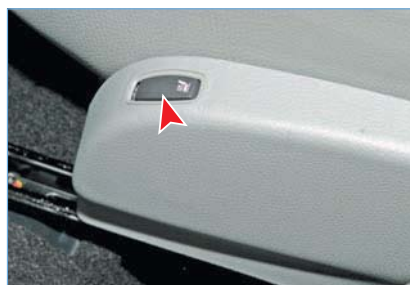
Расположение клавиши выключателя обогрева переднего сиденья
