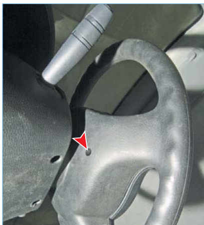
Поворачиваем рулевое колесо так, чтобы с его обратной стороны можно было отвернуть один из двух винтов крепления подушки безопасности.
