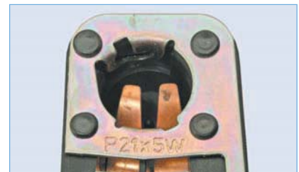
На держателе ламп около каждого патрона указана мощность данной лампы
