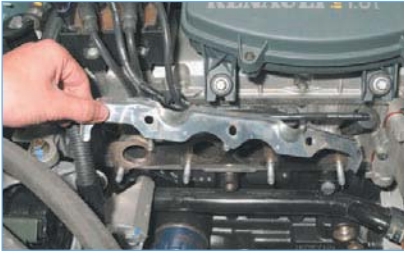
Снимаем теплоизоляционный щиток...
