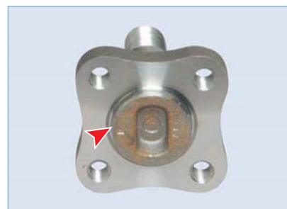
Цилиндрический буртик, выполненный на цапфе, предназначен для центрирования щита тормозного механизма
