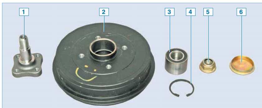
Узел подшипника заднего колеса: 1 — цапфа; 2 — барабан тормозного механизма; 3 — подшипник заднего колеса; 4 — стопорное кольцо подшипника; 5 — гайка подшипника; 6 — колпачок
