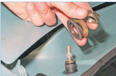
...и снимаем с вала мотор-редуктора гайку, шайбу и уплотнитель. Аналогичные операции выполняем на другом вале очистителя. Нажав на фиксатор...
