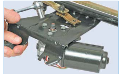
Головкой «на 10» отворачиваем три болта крепления мотор-редуктора к кронштейну очистителя...
