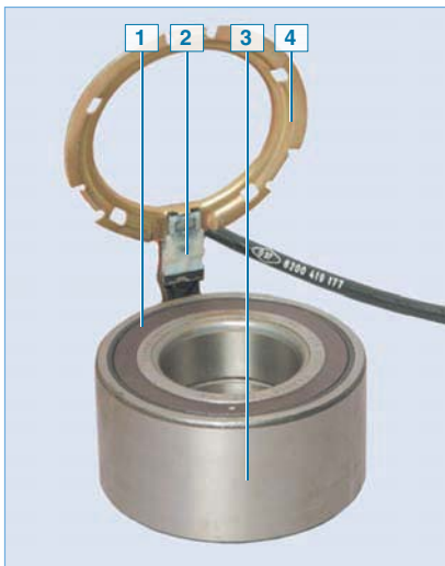
Элементы датчика скорости переднего колеса: 1 — защитная шайба подшипника; 2 — датчик скорости; 3 — подшипник ступицы; 4 — установочное кольцо датчика скорости
