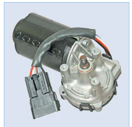
...и снимаем мотор-редуктор. Устанавливаем мотор-редуктор на кронштейн очистителя в обратной последовательности. Для установки вала мотор-редуктора очистителя ветрового стекла в исходное положение надеваем клемму
