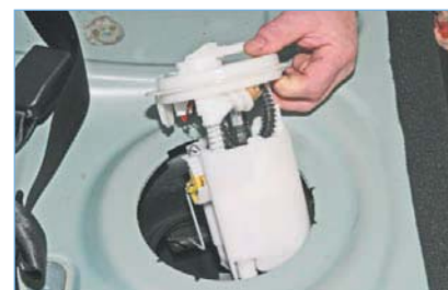
Вынимаем топливный модуль из бака, выводя поплавков датчика указателя уровня топлива из отверстия в топливном баке.
