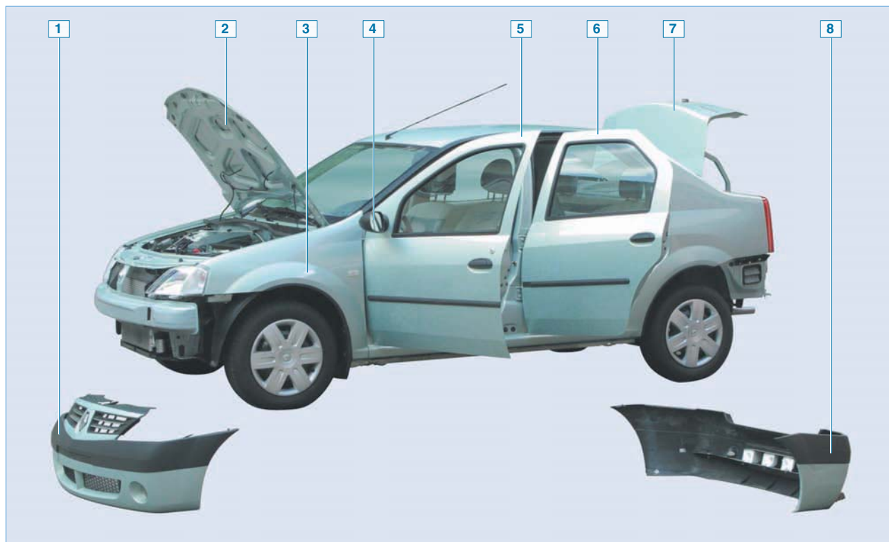
Съемные элементы кузова: 1 — передний бампер с облицовкой радиатора; 2 — капот; 3 — переднее крыло; 4 — наружное зеркало заднего вида; 5 — передняя дверь; 6 — задняя дверь; 7 — крышка багажника; 8 — задний бампер
