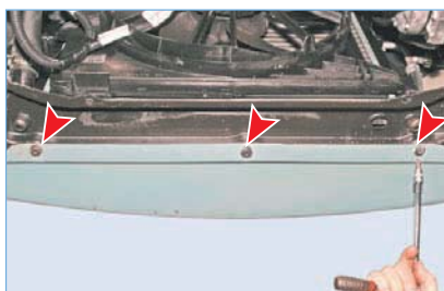
Тем же инструментом отворачиваем три винта крепления бампера к подрамнику. Открыв капот...
