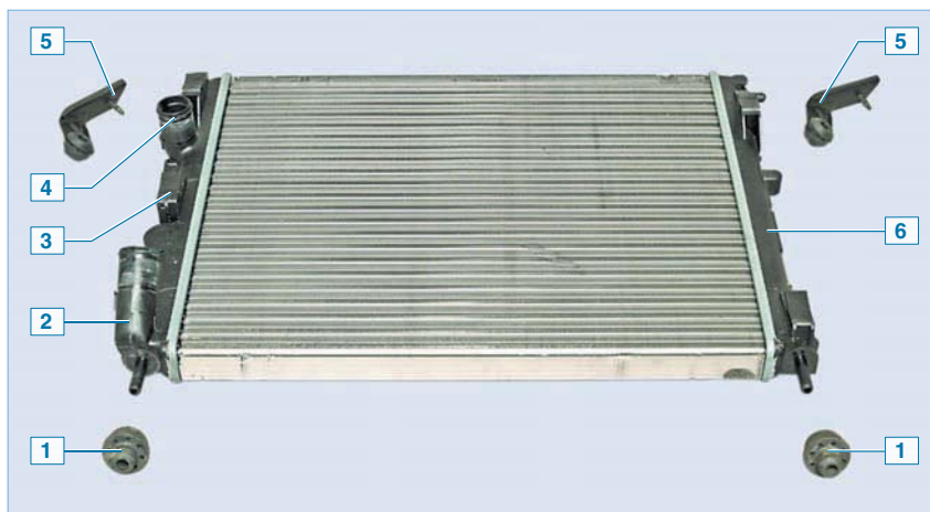
Радиатор: 1 — резиновая подушка нижнего крепления; 2 — отводящий патрубок; 3 — левый бачок; 4 — подводящий патрубок; 5 — кронштейн с подушкой верхнего крепления; 6 — правый бачок
