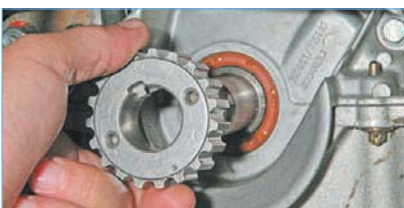
...и снимаем его с носка коленчатого вала.
