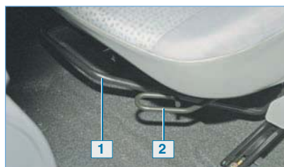
Расположение рычагов регулировки водительского сиденья: 1 — рычаг регулировки сиденья в продольном направлении; 2 — рычаг регулировки сиденья по высоте
