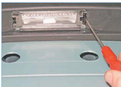
Отжимаем отверткой пластмассовый фиксатор фонаря...
