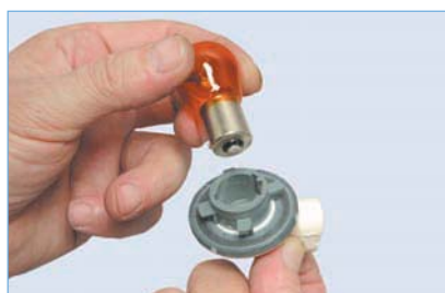
...и вынимаем из патрона.
