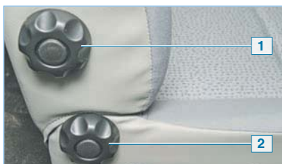
Расположение ручек регулировки водительского сиденья: 1 — ручка регулировки поясничного упора; 2 — ручка регулировки наклона спинки сиденья
