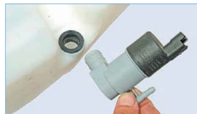
Снимаем уплотнительную втулку с патрубка насоса.
