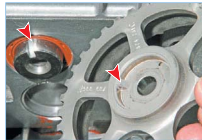
Устанавливаем зубчатый шкив на распределительный вал так, чтобы выступ на шкиве вошел в паз на носке распределительного вала.
