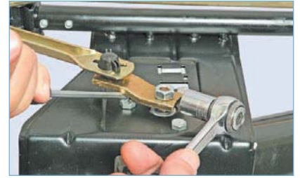
Головкой «на 13» отворачиваем гайку крепления кривошипа очистителя, удерживая кривошип отверткой.
