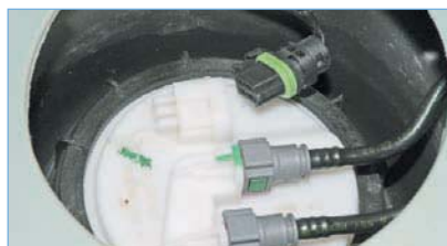
Отжав фиксатор, отсоединяем колодку жгута проводов от разъема крышки топливного модуля...
