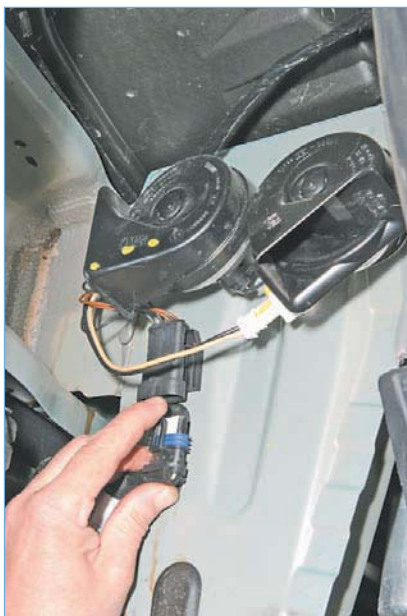
...отсоединяем колодку проводов противотуманных фар от колодки жгутов проводов.
