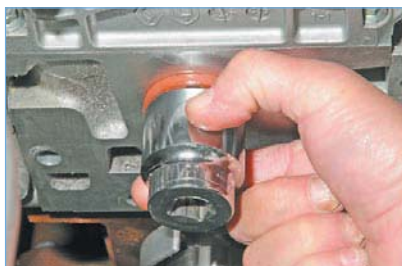
Запрессовываем сальник с помощью инструментальной головки или оправки подходящего диаметра.
