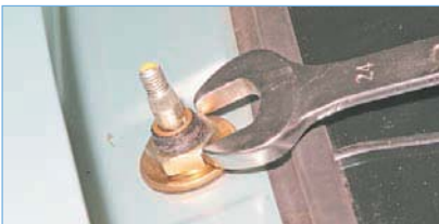
Ключом «на 24» отворачиваем гайку...
