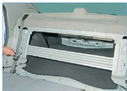
Головкой «на 13» отворачиваем четыре болта крепления стяжки...
