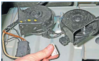
Отсоединяем колодку проводов от звукового сигнала высокого тона.
