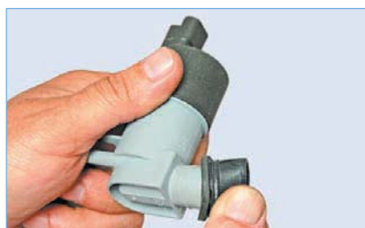
Снимаем уплотнительную втулку с патрубка насоса.
