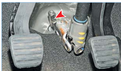
Специальный болт и гайка крепления муфты нижнего карданного шарнира промежуточного вала
