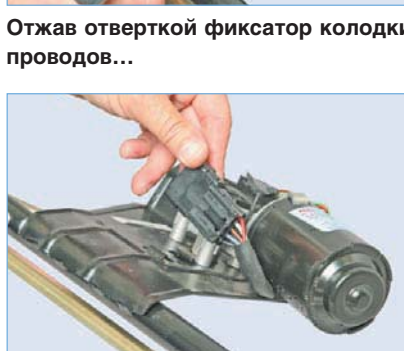
...выводим колодку проводов из направляющих кронштейна.
