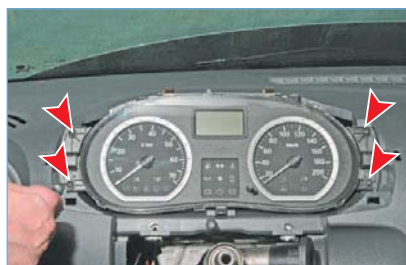
...и снимаем накладку.
