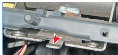
Расположение выступа кронштейна поперечной балки панели приборов (рулевая колонка снята)
