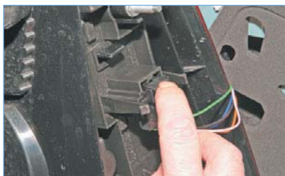
Нажав на фиксатор колодки проводов...
