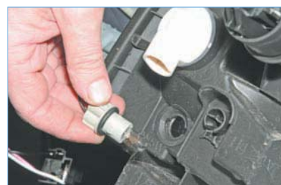
...и извлекаем патрон с лампой из корпуса блок-фары.
