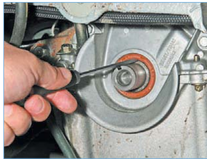
Поддев отверткой сальник... ...извлекаем его из посадочного гнезда в передней крышке блока цилиндров.
