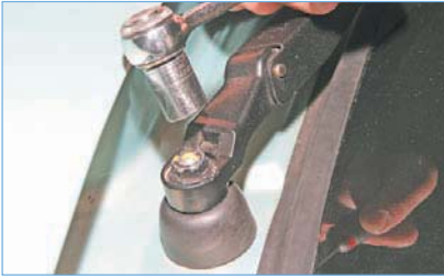
Головкой «на 13» отворачиваем гайку крепления рычага стеклоочистителя.
