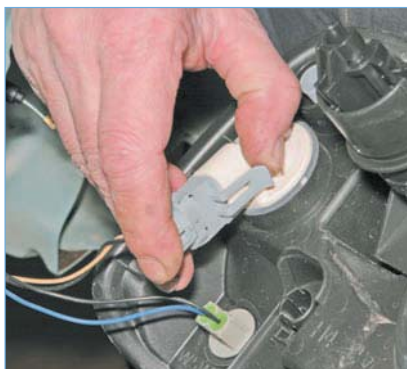
...отжимаем фиксатор колодки проводов...
