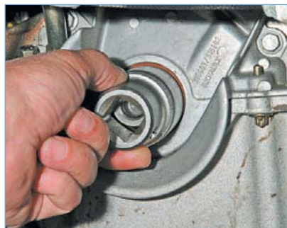
...запрессовываем сальник инструментальной головкой или отрезком трубы подходящего размера.
