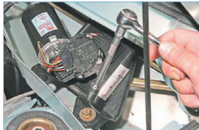
Головкой «на 10» отворачиваем болт крепления кронштейна очистителя.
