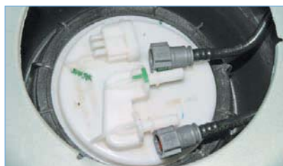
Отжав фиксатор, отсоединяем колодку жгута проводов от разъема крышки топливного модуля...
