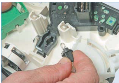
Вынимаем патрон с лампой.
