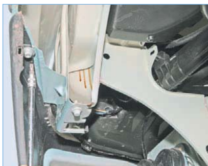
...ключом «Torx T-30» отворачиваем по одному винту его бокового крепления.
