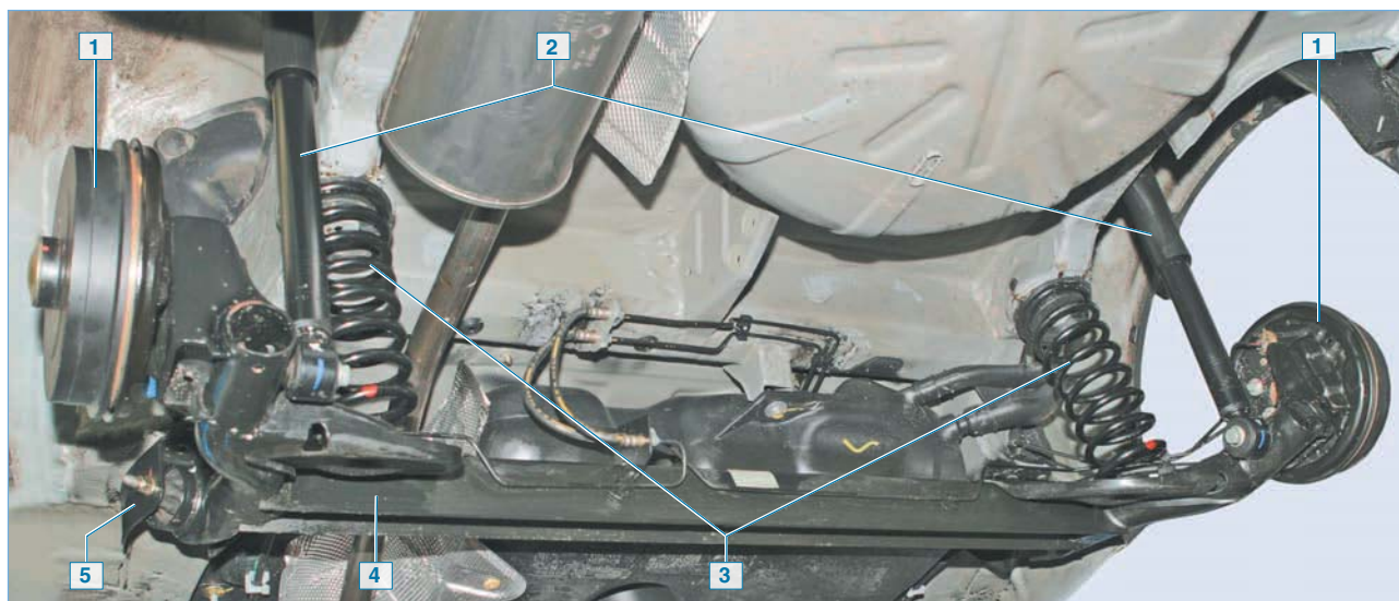
Задняя подвеска: 1 — барабан тормозного механизма; 2 — амортизатор; 3 — пружина; 4 — балка задней подвески; 5 — кронштейн крепления рычага балки к кузову
