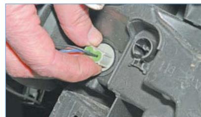
Поворачиваем патрон лампы габаритного света (для правой фары — против часовой стрелки)...
