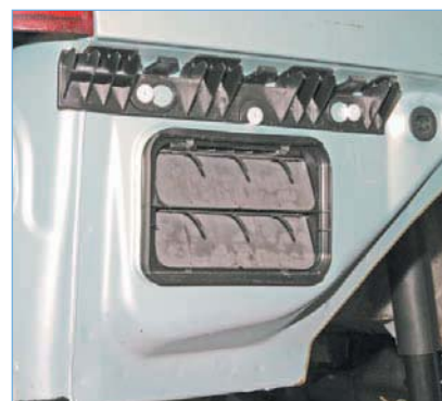
Клапаны выхода воздуха из салона (при снятом заднем бампере)
