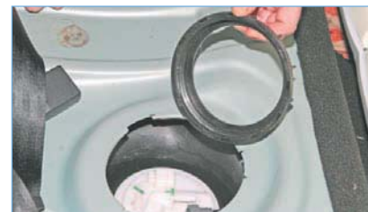
Вынимаем прижимное кольцо топливного модуля.
