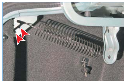
Натяжение пружин петель багажника регулируется перестановкой их в кронштейнах в одно из трех положений
