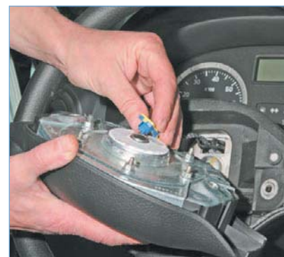
...и отсоединяем колодку кабеля от подушки безопасности.
