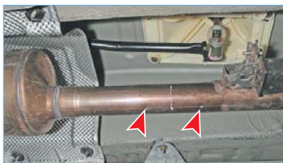
Расположение меток на трубе между нейтрализатором и дополнительным глушителем
