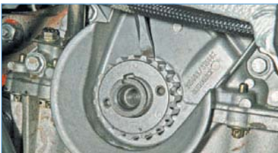
Поддеваем шлицевой отверткой зубчатый шкив коленчатого вала...
