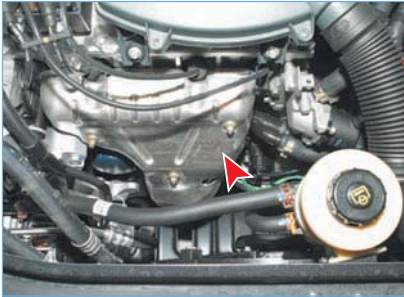
Выпускной коллектор закрыт теплозащитным экраном...
