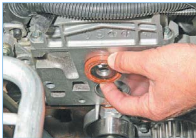
...надеваем сальник на носок распределительного вала.
