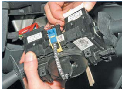
...сдвигаем соединитель с рулевой колонки.
