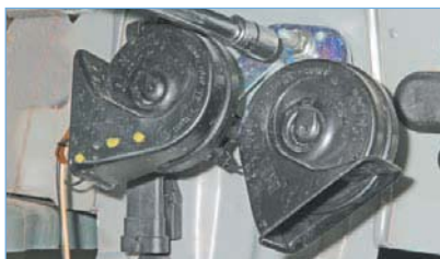
Ключом «на 13» отворачиваем гайку крепления кронштейна звуковых сигналов...
