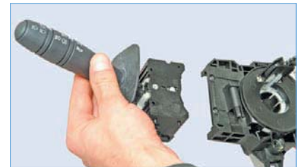
Вынимаем левый подрулевой переключатель из соединителя.
