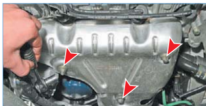
Головкой «на 10» отворачиваем три гайки крепления теплозащитного экрана...
