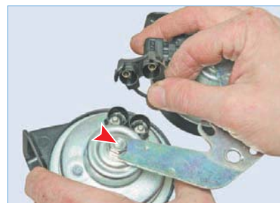
Поддеваем отверткой фиксатор контактного разъема звукового сигнала низкого тона...
