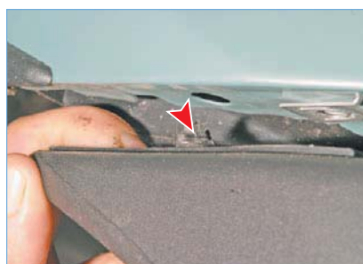
...а штифт на бампере должен войти в отверстие кузова.
