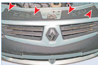
...тем же ключом отворачиваем четыре винта крепления бампера к верхней поперечине рамки радиатора.
