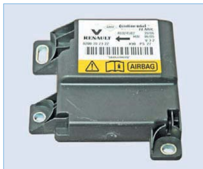
...и снимаем блок управления подушками безопасности.
