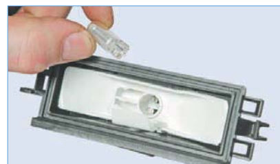
Вынимаем лампу из фонаря.
