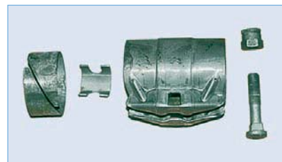
Соединяют трубы нового узла с трубами системы выпуска специальным хомутом
