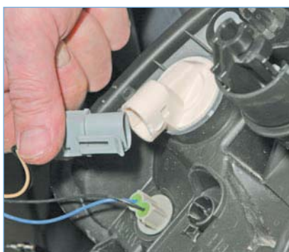
...и отсоединяем колодку от патрона лампы указателя поворота.
