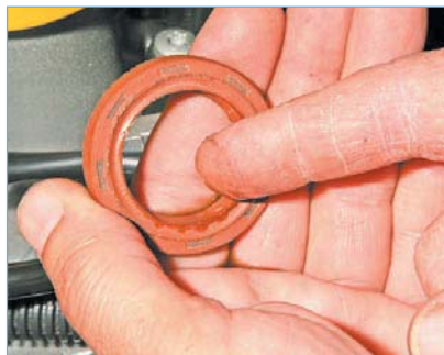
Нанеся на рабочую кромку нового сальника тонкий слой моторного масла...
