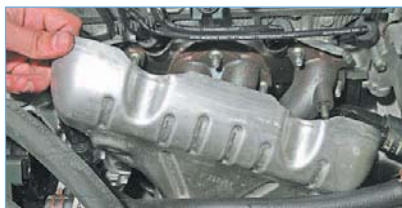
...и снимаем экран.
