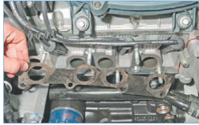
...и прокладку выпускного коллектора.
