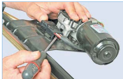
Отжав отверткой фиксатор колодки проводов...
