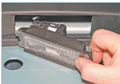
...и вынимаем фонарь из отверстия заднего бампера.
