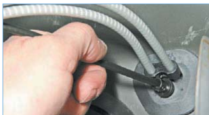
Вытягиваем пластмассовую втулку оболочки троса из резинового уплотнителя на щитке передка и вынимаем трос в салон.
