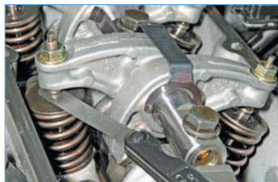
Расположение клапанов в головке блока цилиндров: 1 — ряд впускных клапанов; 2 — ряд выпускных клапанов
