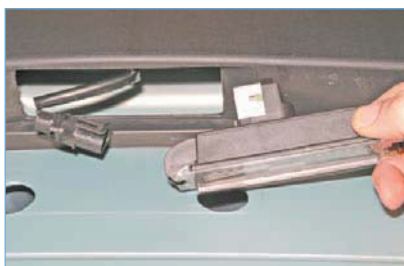
...отсоединяем колодку проводов от фонаря.
