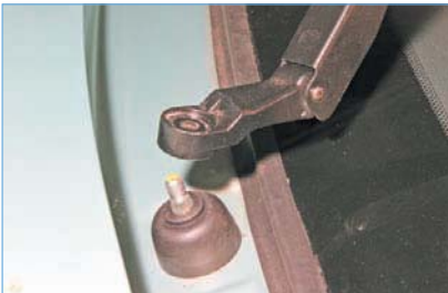
Снимаем с вала мотор-редуктора рычаг со щеткой.
