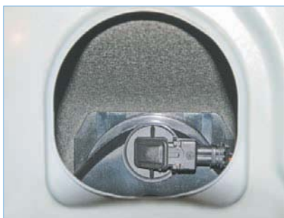
Внутри багажника, через отверстие в задней полке, поворачиваем против часовой стрелки патрон лампы...
