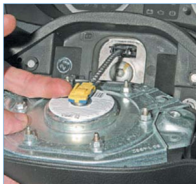
Подцепив фиксатор колодки спирального кабеля подводки питания к подушке...
