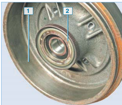
Расположение задающего диска датчика скорости заднего колеса: 1 — барабан тормозного механизма; 2 — задающий диск датчика скорости
