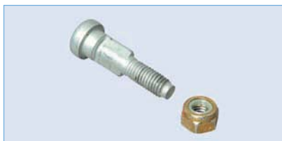
Специальный болт и гайка крепления муфты нижнего карданного шарнира промежуточного вала
