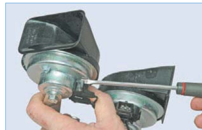
Поддеваем отверткой фиксатор контактного разъема звукового сигнала низкого тона...
