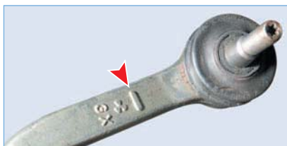
На правом наконечнике рулевой тяги нанесена одна метка...
