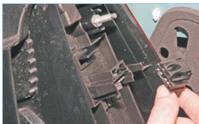
...отсоединяем колодку проводов от фонаря...
