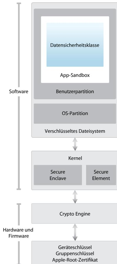
Diagramm der Sicherheitsarchitektur von iOS mit einem grafischen Überblick über die verschiedenen Technologien, auf die in diesem Dokument näher eingegangen wird
