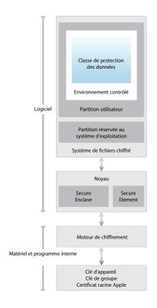
Le schéma de l'architecture de sécurité d'iOS fournit une vue d'ensemble des différentes technologies présentées dans ce document.
