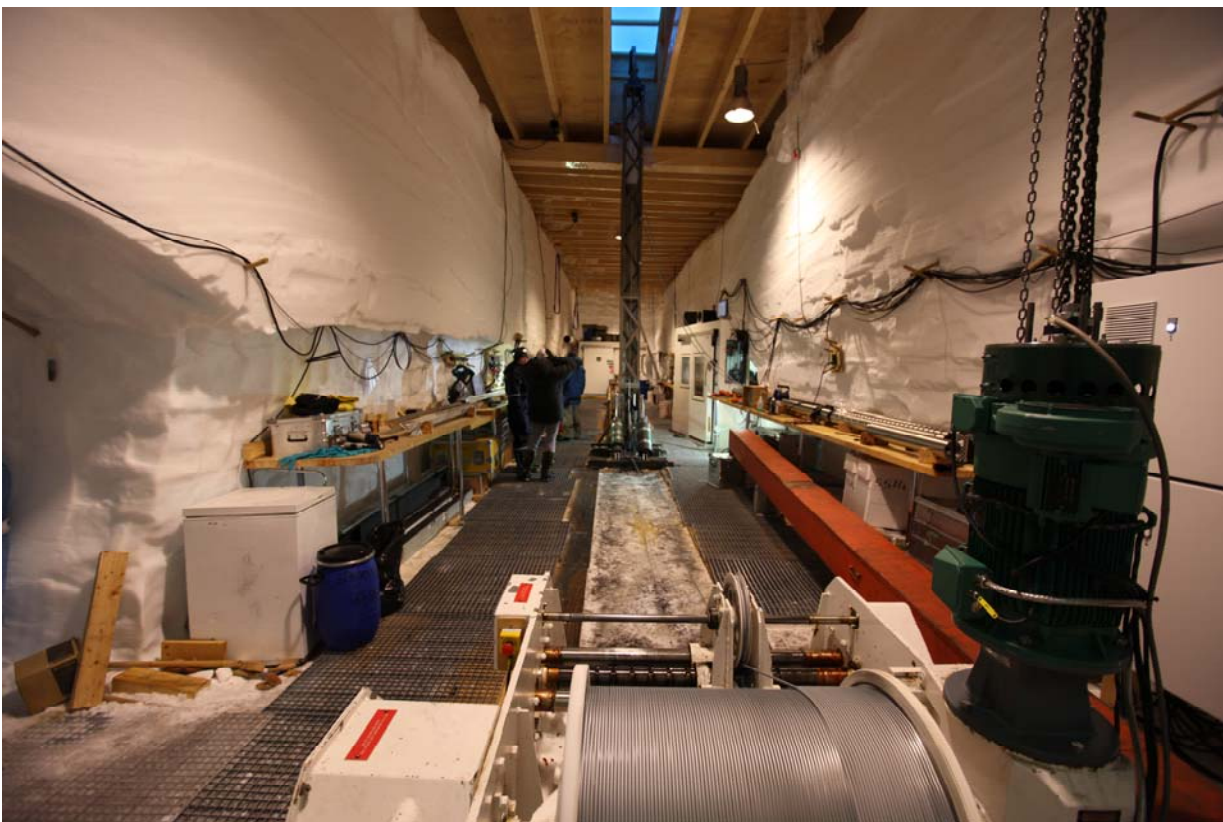
Tranchée de forage de NEEM. On distingue au premier plan le treuil avec 3000 mètres de câble ; au milieu, le mât-support du carottier, en position verticale. La surface de la calotte de glace se situe au-dessus du plafond en bois. Crédit photo : Lucia Simion.
