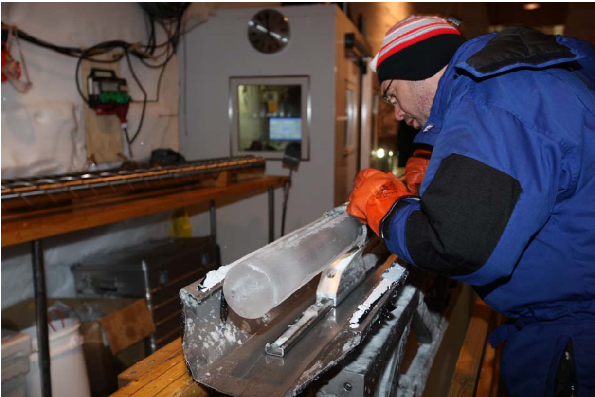
Extraction d'une carotte de glace sur le site de NEEM, sous le contrôle d'Olivier Alemany, ingénieur du LGGE en charge du C2FN/Glaciologie. Crédit photo : Lucia Simion.
