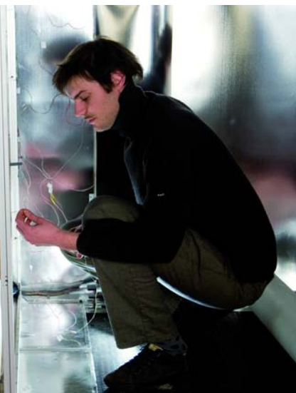
Étude thermique d'une mince paroi comportant des capsules de cire. Celles-ci sont destinées à capter les excès de chaleur libérés dans un bâtiment.
