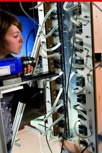
Cette expérience permet d'étudier la manière dont la chaleur d'un panneau solaire se transmet à la façade.
