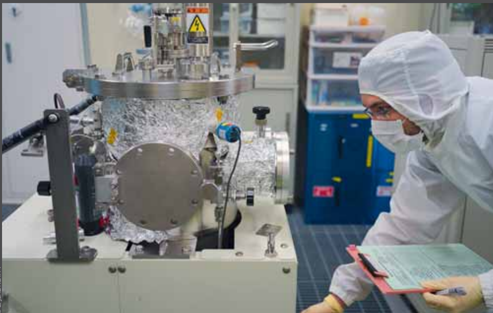
Amaury Delamarre, du Laboratoire international associé NextPV, à Tokyo, travaille à la fabrication de couches anti-réfléchissantes pour des cellules solaires.
