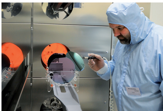
Plateforme micro- et nanotechnologies : four automatisé pour la croissance et le dépôt de matériaux à base de silicium.
