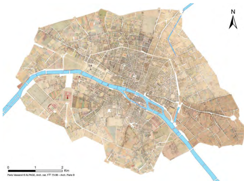
Fig1 L'assemblage des 910 feuilles Vasserot. Le plus ancien parcellaire de Paris a été reconstitué grâce au géoréférencement puis à la vectorisation des 910 plans d'îlots Vasserot (1810-1836, dans la limite des Fermiers généraux).
