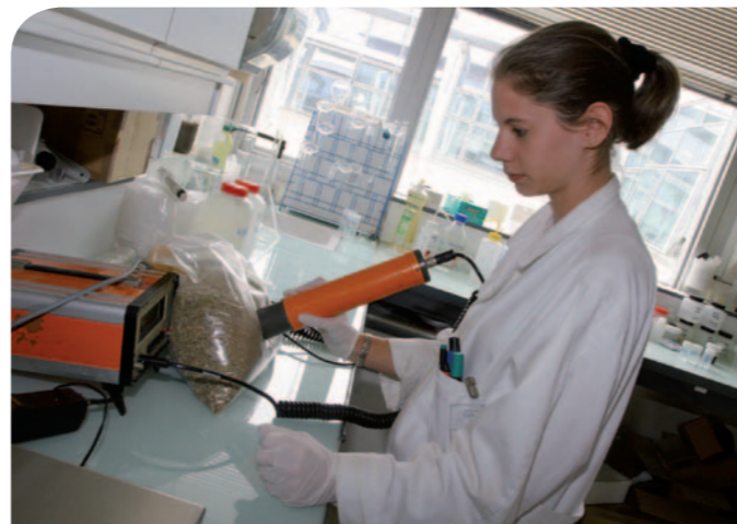
▲ Mesure de la radioactivité lors de la réception d'un échantillon au Laboratoire de physique subatomique et des technologies associées (Subatech) à Nantes.
