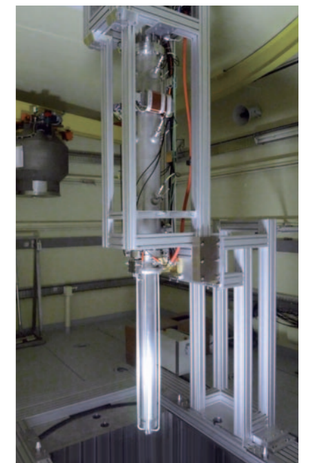
▼ Insertion de la ligne verticale de l'accélérateur Genepi-3C dans le cœur du réacteur de Guinevere.
