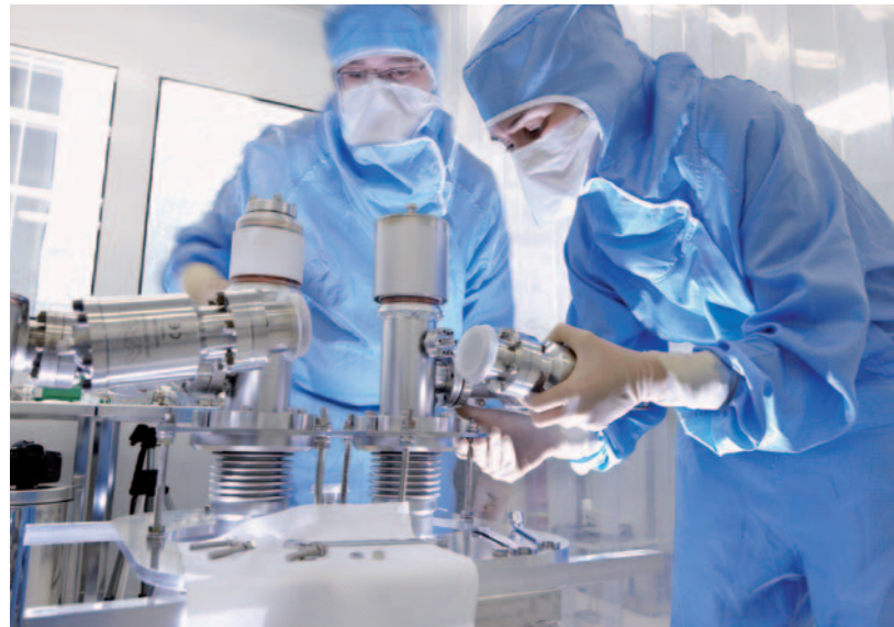
▲ Coupleurs de puissance permettant d'atteindre de hautes fréquences dans les cavités accélératrices de XFEL. Ceux de l'ILC seront basés sur la même technologie. Salle blanche du Laboratoire de l'accélérateur linéaire (LAL) à Orsay.
