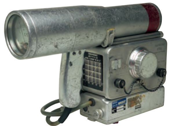
Herover: Et af geologernes vigtige redskaber til opmåling af den samlede radioaktivitet: scintillometret SPP-2.
