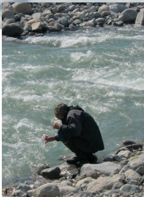
Både før, under og efter etableringen af en mine udtages vandprøver for at overvåge miljøet. Her er det Nalunaq Gold Mine AIS's laboratorieansvarlige, som indsamler vandprøver fra elven i Kirkespirdalen.
