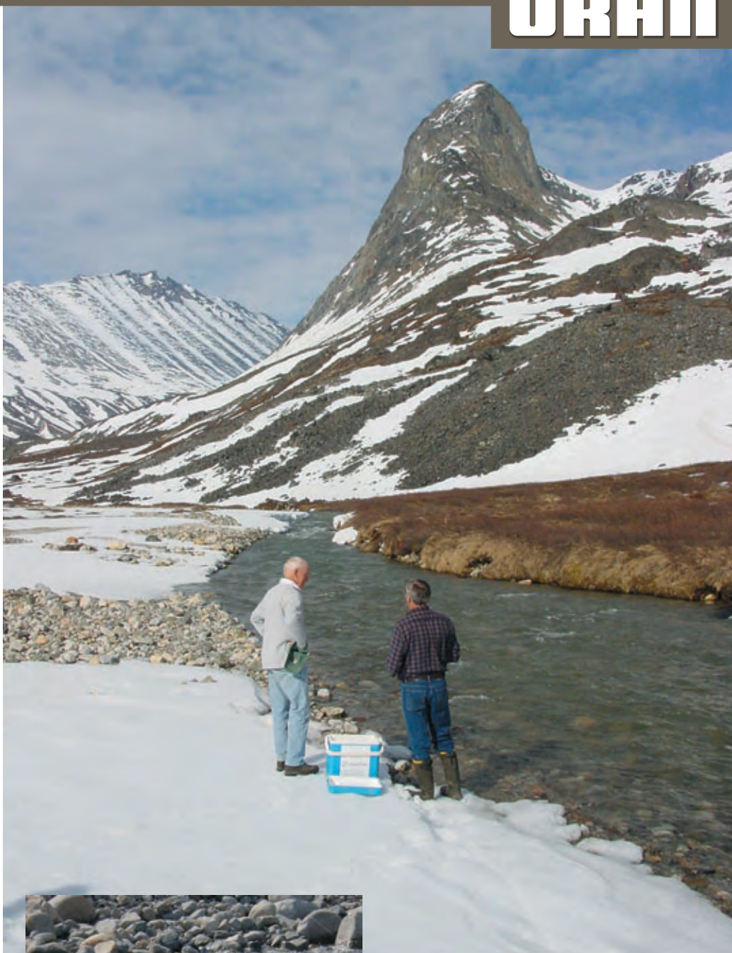
Både før, under og efter etableringen af en mine udtages vandprøver for at overvåge miljøet. Her er det Nalunaq Gold Mine AIS's laboratorieansvarlige, som indsamler vandprøver fra elven i Kirkespirdalen.
