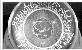
Todo analógico. La información fue insertada en el disco mediante un sistema de irradiación de iones.
