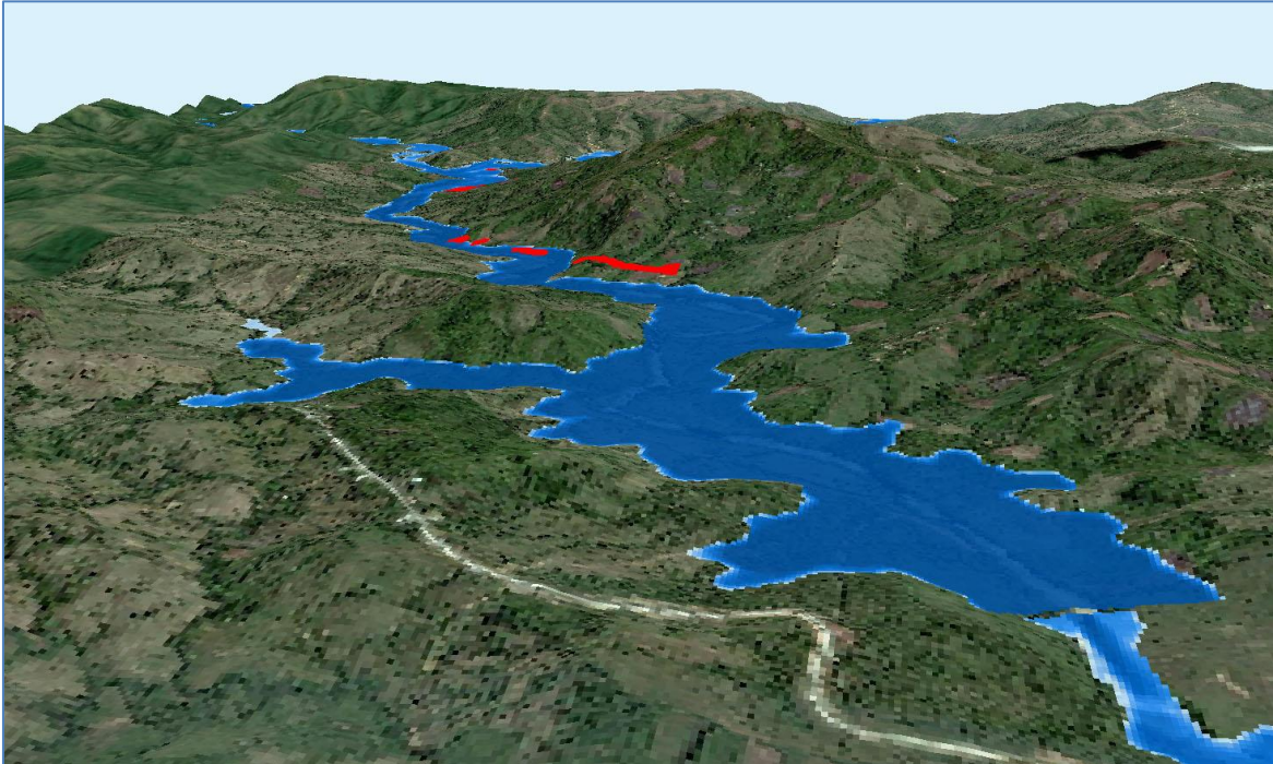
Figura 3.- Simulación del vuelo sobre la zona inundada con la crecida de 100 años y la presa: captura de pantalla del vídeo (casas de las comunidades afectadas en rojo)
