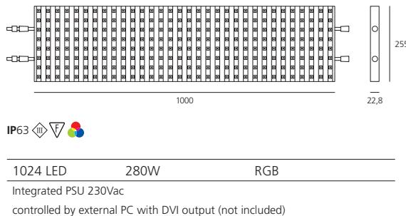
Il Pixel Mesh è una matrice di LED RGB che possono essere controllati al fine di creare qualunque tipo di immagine, scritta o scenario luminoso, secondo le necessità dell'installazione e del cliente.
