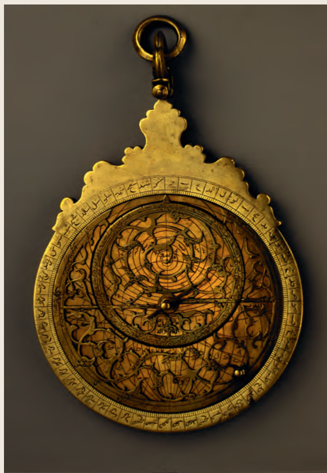
Astrolabe planisphérique, instrument utilisé pour mesurer la hauteur des astres au-dessus de l'horizon (XVI e siècle). Photo tirée de l'exposition « L'âge d'or des sciences arabes, en partenariat avec l'Institut du Monde Arabe ».
