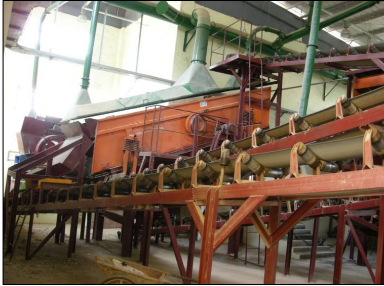
图 4.3 中信华威建材公司建筑垃圾粉碎及传输设备 (来源：北京大学深圳研究生院等，2008)
