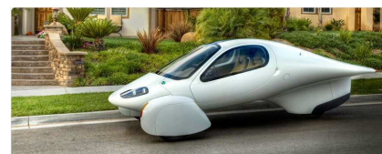
Obrázok 20.40. Aptera: 6 kWh na 100 km. Fotografia od www.aptera.com.
