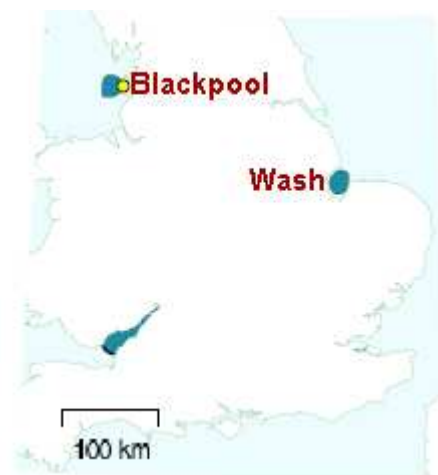
Obrázok 14.9. Dve prílivové lagúny, každá s rozlohou 400 \text{ m}^2 , jedna pri meste Blackpool, a jedna v zátok Wash. Pre porovnanie je zobrazené ústie Severn.
