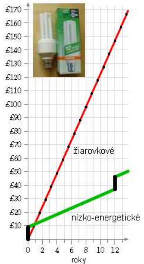
Obrázok 9.3. Celkové kumulatívne náklady používania tradičnej 100 W žiarovky pri 3 hodinách svietenia, v porovnaní s okamžitým nahradením žiarivkou Osram Dulux Longlife (na obrázku). Predpoklady: cena elektriny 10 pencí za kWh; výmena tradičnej žiarovky stojí vždy 45 pencí; úsporná žiarivka stojí 9 £. (Viem, že ich možno kúpiť aj lacnejšie, ale graf ukazuje, že aj pri tejto cene sú oveľa ekonomickejšie.)
