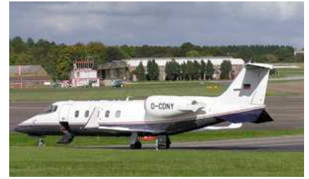
Obrázok C.10. Bombardér Learjet 60XR prepravujúci osem pasažierov pri rýchlosti 780 km/h spotrebuje 150 kWh na 100 osobo-km.
