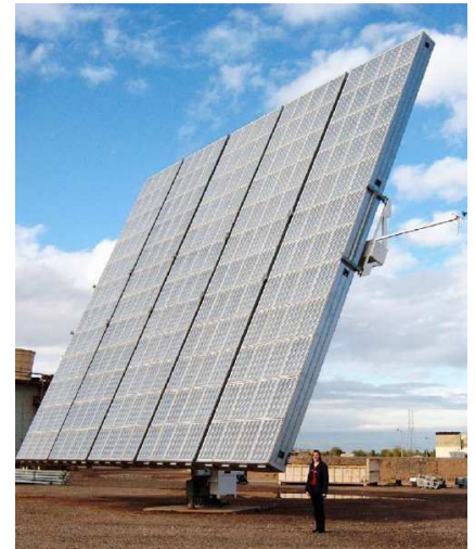
Obrázok 25.9. 25 kW (maximum) koncentračný fotovoltaický panel od kalifornského výrobcu spoločnosti Amonix. Jeho 225 \text{ m}^2 obsahuje 5760 Fresnelových šošoviek s 260-násobnou optickou koncentráciou, z ktorých každá osvetľuje kremíkový článok s 25 % účinnosťou. Jeden takýto článok, na vhodnej lokalite na púšti, vyrobí denne 138 kWh – dosť pre pokrytie polovice spotreby energie priemerného Američana. Všimnite si človeka, pre znázornenie proporcie. Fotografia David Faiman.
