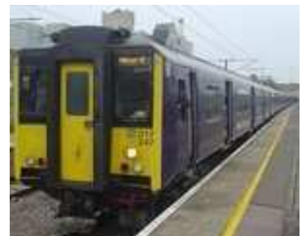
Obrázok 20.4. Osobný vlak s 8 vagónmi z Cambridge do Londýna spotrebuje pri maximálnej rýchlosti 100 míľ za hodinu (161 km/h) 1,6 kWh na 100 osobo-km, ak je plný.
