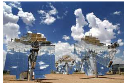
Obrázok 25.3 Stirlingov tanierový motor. Tieto nádherné koncentrátoory dodávajú plošný výkon 14 \text{ W/m}^2 [kombinácia solárnych kolektorov a Stirlingových motorov – pozn. prekl.]. Fotografia s láskavým povolením od Stirling Energy Systems. www.stirlingenergy.com
