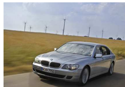
Obrázok 20.26. BMW Hydrogen 7. Spotreba energie: 245 kWh na 100 km. Fotografia od BMW.
