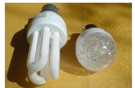
Obrázok 9.4. Philips 11 W vedľa Omicron 1,3 W LED žiarovky.
