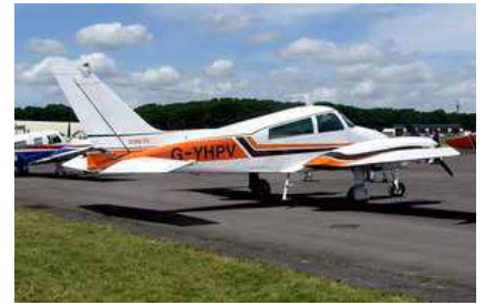
Obrázok C.9. Cessna 310N: 60 kWh na 100 osobo-km. Cessna 310 Turbo odvezie 6 pasažierov (vrátane pilota) rýchlosťou 360 km/h. Fotografia Adrian Pingstone.
