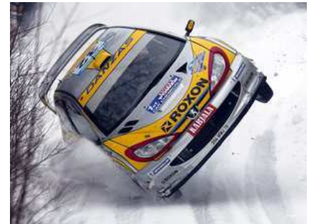
Obrázok A.1. Peugeot 206 má koeficient odporu 0.33. Fotografia Christopher Batt.
