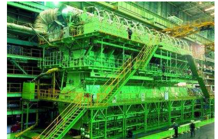
Obrázok A.15. Wartsila- Sulzer RTA96-C 14 cylindrový dvojtaktný dieselový motor. 27 metrov dlhý a 13,5 metrov vysoký. http://www.wartsila.com/
