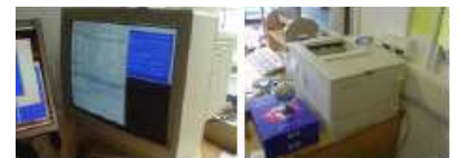
LCD: CRT: 31 W 108 W Tlačiareň: 17 W zap., nečinná
