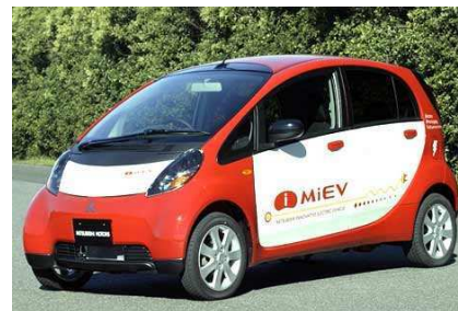
Obrázok 20.38. MiEV od korporácie Mitsubishi Motors Fotografia od www.think.no. Má 47 kW motor, má hmotnosť 1080 kg, maximálnu rýchlosť 130 km/h.
