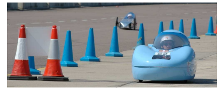
Obrázok 20.2. Eko-auto od Team Crocodile spotrebuje 1,3 kWh na 100 km. Fotografia láskavo poskytol Team Crocodile. http://www.teamcrocodile.com/
