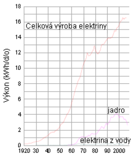
Tabuľka K. 5. História výroby celkovej elektriny, elektriny z vody a elektriny z jadra v Británii. Výkony sú vyjadrené „na osobu“, vydelením každého výkonu 60 miliónmi.
