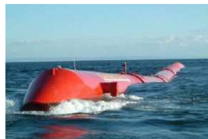
Obrázok 12.1. Kolektor energie vln Pelamis je morský had vyrobený zo štyroch častí. Nosom je nasmerovaný na prichádzajúce vlny. Vlny hada naťahujú, a tomuto pohybu odporujú hydraulické generátory. Maximálna energia z jedného hada je 750 kW; v najlepšej lokalite v Atlantiku by jeden had mohol dodať v priemere 300 kW. Fotografia od výrobcu vlnovej energie Pelamis www.pelamiswave.com .
