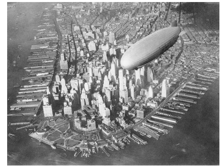
Obrázok C.14. 239 m dlhá vzducholod' USS Akron (ZRS-4) pri prelete nad Manhattanom. Mala hmotnosť 100 t a uniesla 83 t. Jej motory mali celkový výkon 3,4 MW a dokázala previesť 89 osôb a množstvo zbraní rýchlosťou 93 km/h. Používala sa aj ako vojenský transportér.
