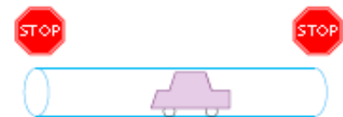
Obrázok A.4. Aby sme zistili, či sa energia spotrebuje hlavne v brzdnom systéme alebo na prekonanie odporu vzduchu, porovnáme hmotnosť vozidla s hmotnosťou vzduchovej trubice medzi dvomi značkami STOP.
