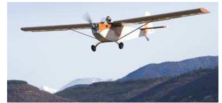
Obrázok C.12. Electra F- WMDJ: 11 kWh na 100 o-km.
