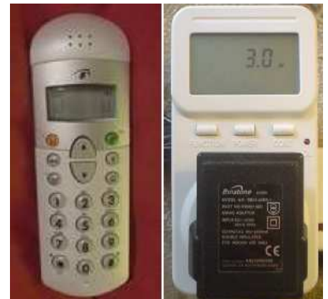
Obrázok 11.3. Tento neefektívny bezdrôtový telefón a jeho nabíjačka spotrebuje 3 W, keď sa nechá v zástrčke. To je 0,07 kWh/d . Ak je cena elektriny 10 pencí za kWh, potom 3W znamenajú 3 libry za rok.
