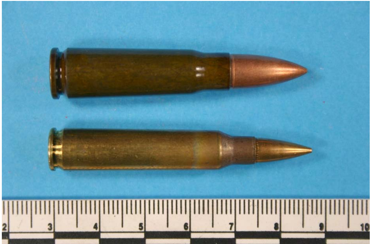
FIGURE N° 56 En haut une cartouche 7,62 x 39 mm En bas une cartouche .223 Remington
