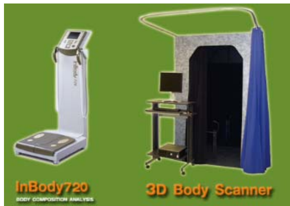
รูปประกอบที่ 4.4.1 เครื่องวัดองค์ประกอบในร่างกาย (ซ้าย) และเครื่องตรวจวัดเรือนร่างสามมิติ (ขวา)
