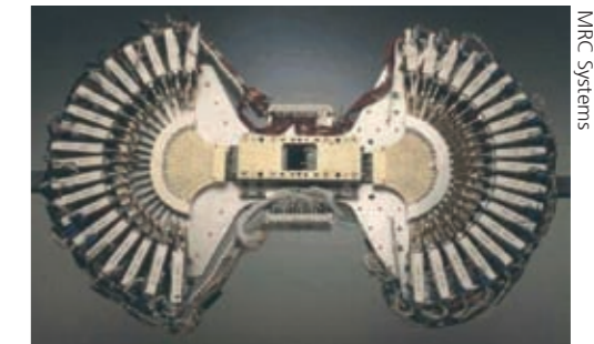
Der Multileaf-Kollimator dosiert die Bestrahlung exakt.
